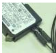
ファイバユニットを接続部へさし 込みます [ファイバユニットの2本のファ イバはどちらにさしこんでもか まいません]
