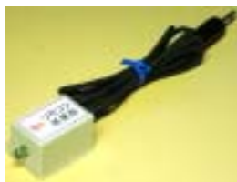
リモコン送信部 リモコン信号を送信します
